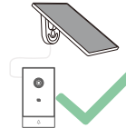
S'assurer que le câble d'alimentation repose naturellement sans tension
